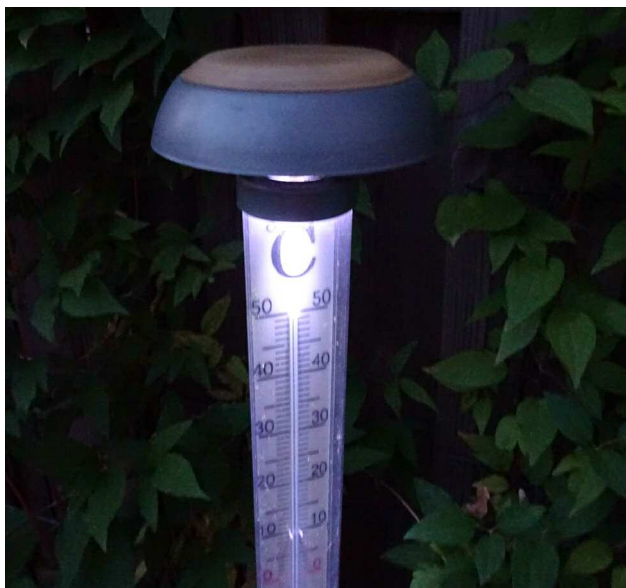
Thermometer met verlichting, bovenin de relatief grote zonnecel, daaronder de printplaat met IC driver, 2 AA accu's en witte LED die voor een deel de temperatuurschaal verlicht.
